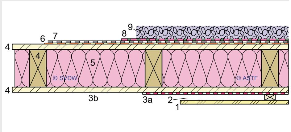
La pente minimale de 1,5% exigée pour l'isolation doit être planifiée et réalisée au moyen de la couche 4 (structure porteuse)
