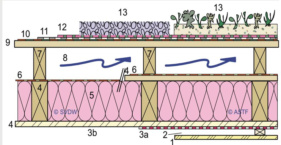
La pente minimale de 1,5% exigée pour l'isolation doit être planifiée et réalisée au moyen de la couche 4 (structure porteuse) ou par la couche 7 (lattage de distancement ou d'inclinaison).
