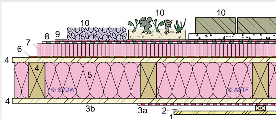
La pente minimale de 1,5% exigée pour l'isolation doit être planifiée et réalisée au moyen de la couche 4 (structure porteuse) ou par la couche 7 (isolation supplémentaire)
