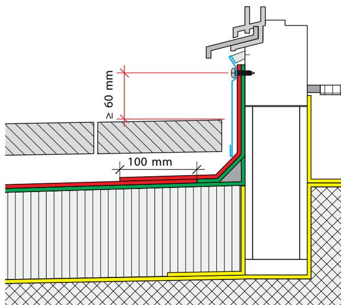
Abb. 26: bituminöse Abdichtung mit Keil und Deckstreifen
