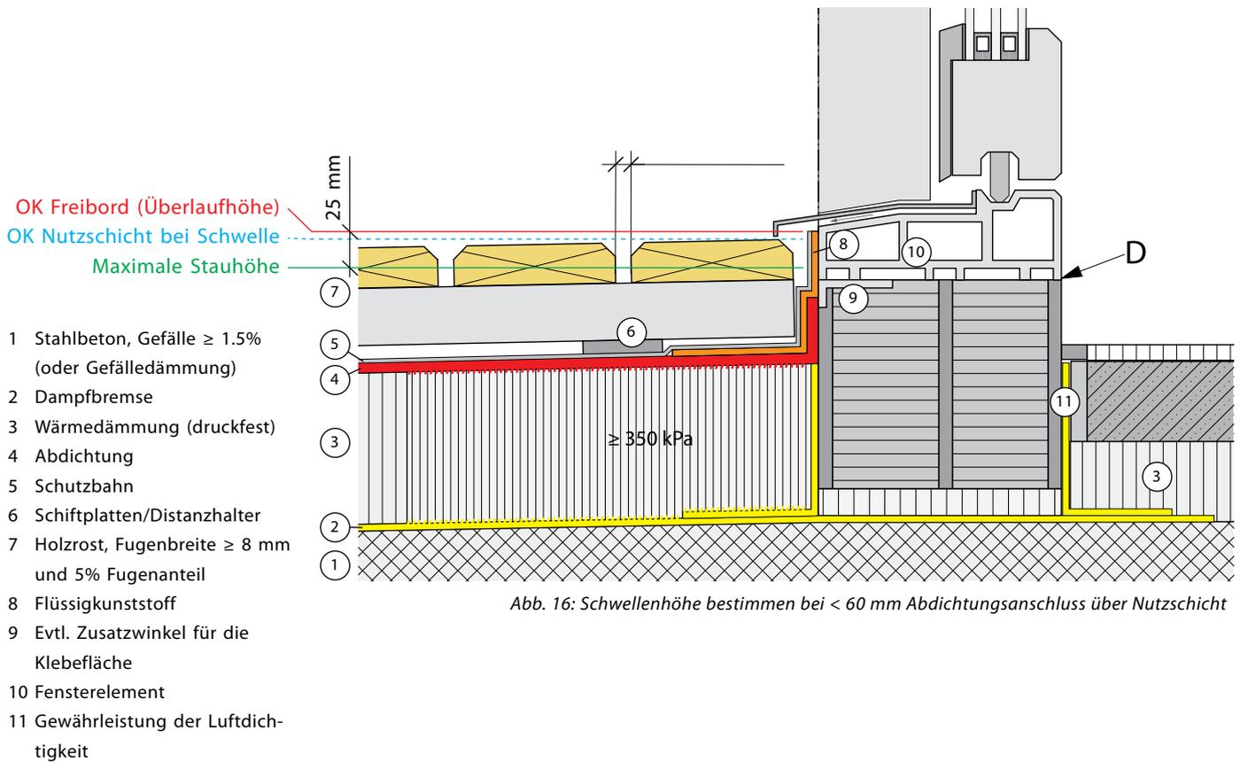
Abb. 16: Schwellenhöhe bestimmen bei < 60 mm Abdichtungsanschluss über Nutzschicht
