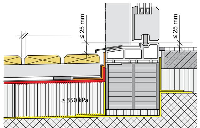
Abb. 22: Schiebetürschwelle und Holzrost; Schwellenhöhe max. 25 mm
