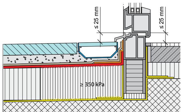
Abb. 23: Fenstertürschwelle und Flachdachrinne; Schwellenhöhe max. 25 mm
