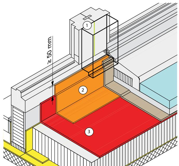
Abb. 37: Elementstoss (1) mit Statikprofil aussen (wenn möglich nachträglich aufgesetzt), FLK (2), Abdichtung (3)
