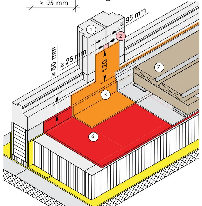
Abb. 49: Elementstoss mit Bewegungsfuge; Rahmen (1), Entkoppelungsband (2), FLK (3), kraftschlüssige Verbindung (4), Metallprofil (5), Abdichtung (6), OK Nutzschrift (7)
