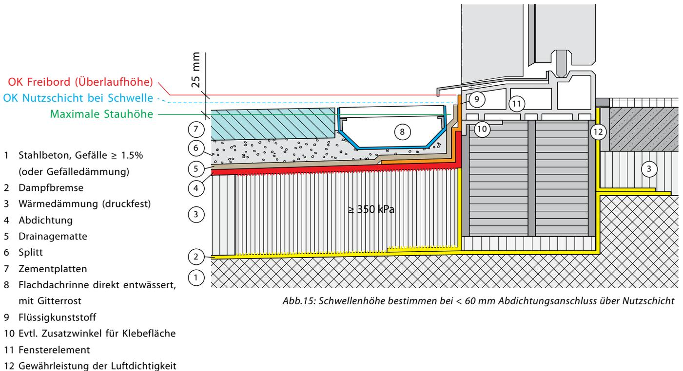
Abb.15: Schwellenhöhe bestimmen bei  $< 60$  mm Abdichtungsanschluss über Nutzschicht
