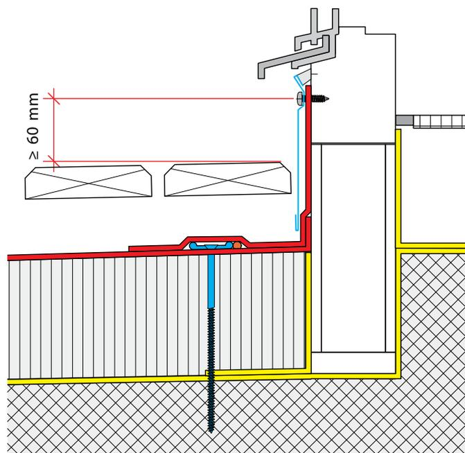
Abb. 25: Kunststoffabdichtung mit mechanischer Befestigung und Deckstreifen
