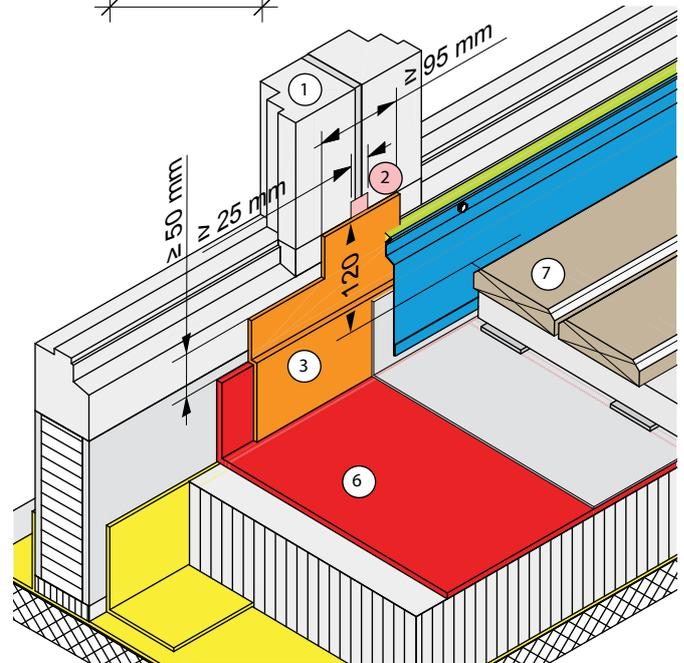
Abb. 36: Elementstoss mit Bewegungsfuge; Rahmen (1), Entkoppelungsband (2), FLK (3), kraftschlüssige Verbindung (4), Metallprofil (5), Abdichtung (6), OK Nutzschiicht (7)
