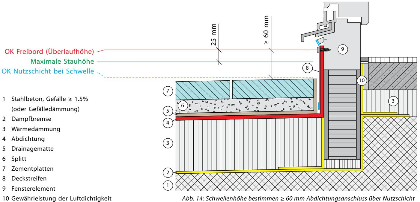
Abb. 14: Schwellenhöhe bestimmen  $\geq 60$  mm Abdichtungsanschluss über Nutzschicht
