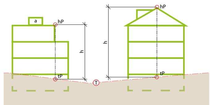
Abb. 1: Gebäudegeometrie;  $T$  = massgebendes Terrain,  $h$  = Gesamthöhe,  $tP$  = tiefster Punkt auf massgebendem Terrain unter der Dachfläche,  $hP$  = höchster Punkt der Dachkonstruktion,  $a$  = technisch bedingte Dachaufbauten (Skizze nach VKF)
