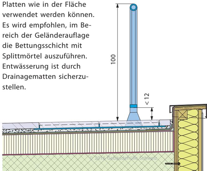
Abb. 19: Systemgeländer mit Auflast der Nuttschicht. Systemanforderungen beachten
