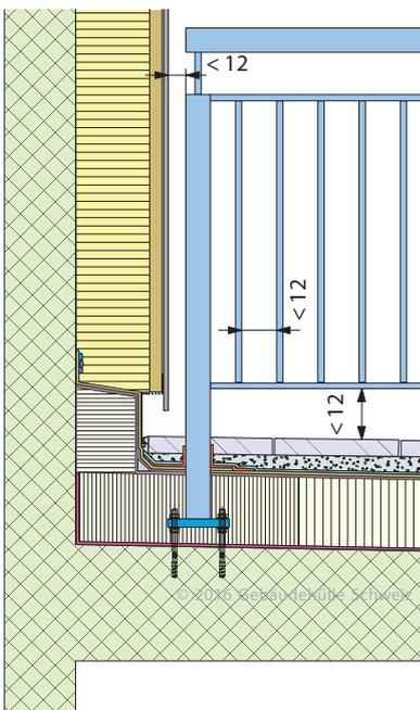
Abb. 10: Höhe von Schutzelementen und Öffnungen in Schutzelementen. Druckfeste Dämmung im Bereich der Konsole ca. 40x40 cm als druckfester Untergrund für die Flüssigkunststoffabdichtung empfehlenswert
