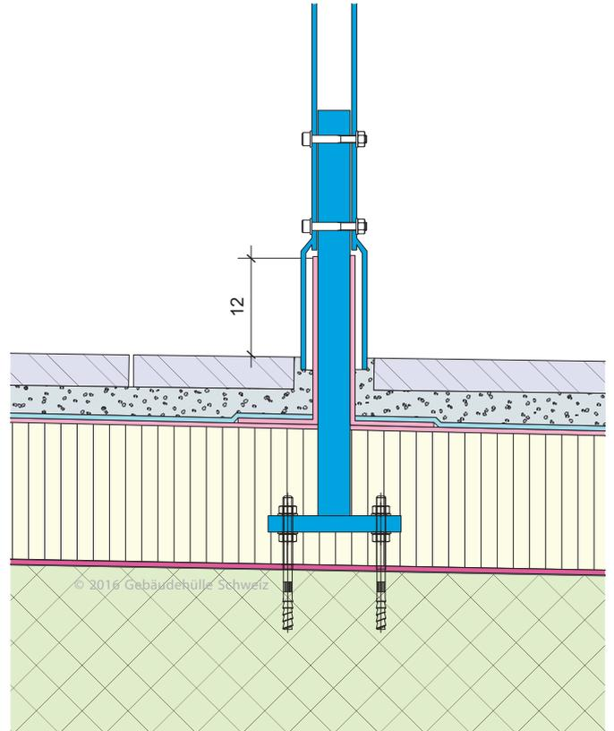
Abb. 17: Geländerkonsole-Abdichtungsanschluss oben offen mit Kunststoff- und Elastomereinfassungen. Geländerpfosten mit Glocke als Abschluss des Abdichtungsanschlusses
