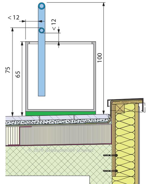
Abb. 9: Pflanztrög als Teil des Schutzelementes. Druckfestigkeit (Dauerdruck) der Wärmedämmung muss berechnet werden. Empfehlung bfu: Pflanztröghöhe 75 cm
