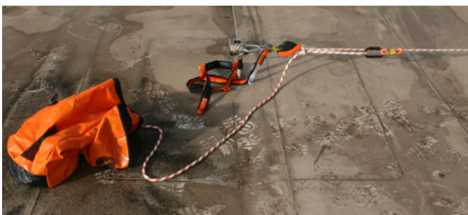
Fig. 11: Descendeur monté dans un système temporaire à corde (ligne de vie) pour la descente (rig for rescue)
