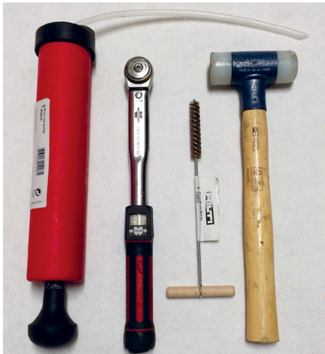
Fig. 40: Kit d'outils avec clé dynamométrique, soufflette, etc. pour le montage des points de fixation
