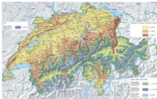
Abb. 3: Staudruckkarte «Einwirkungen auf Tragwerke» Staudruck (Anhang E) Auszug aus der Norm SIA 261
