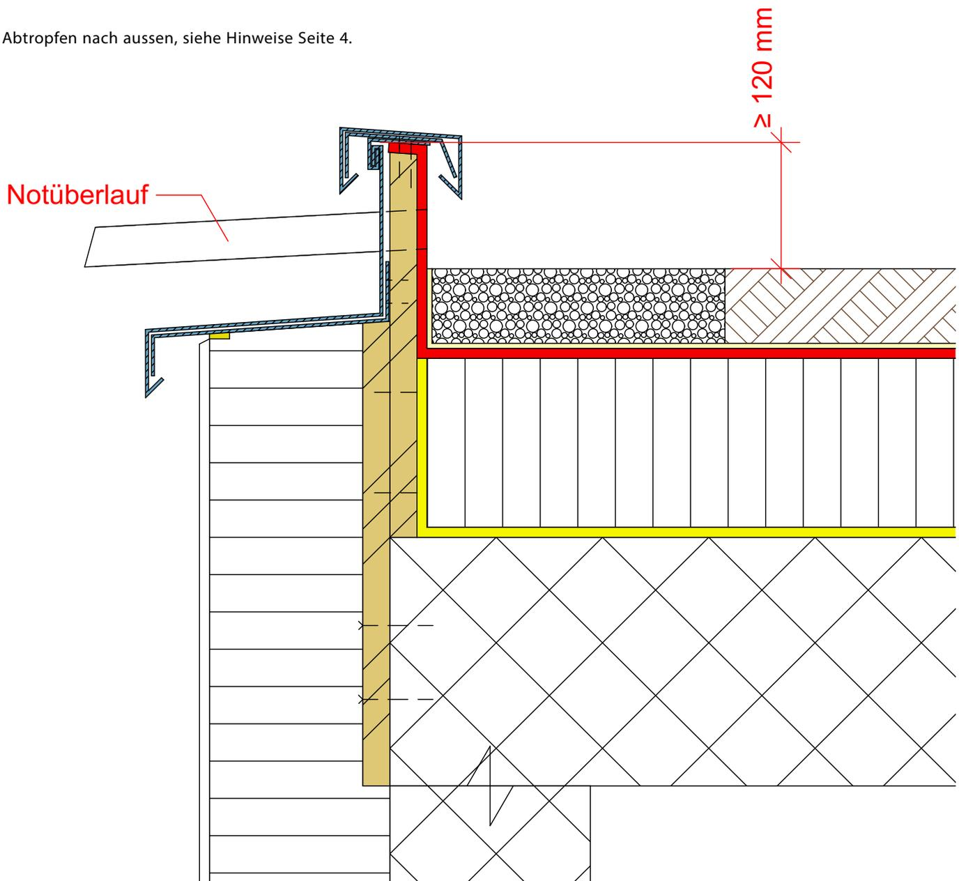
Abb. 33: Nicht überlaufsichere Dachrandkonstruktionen
