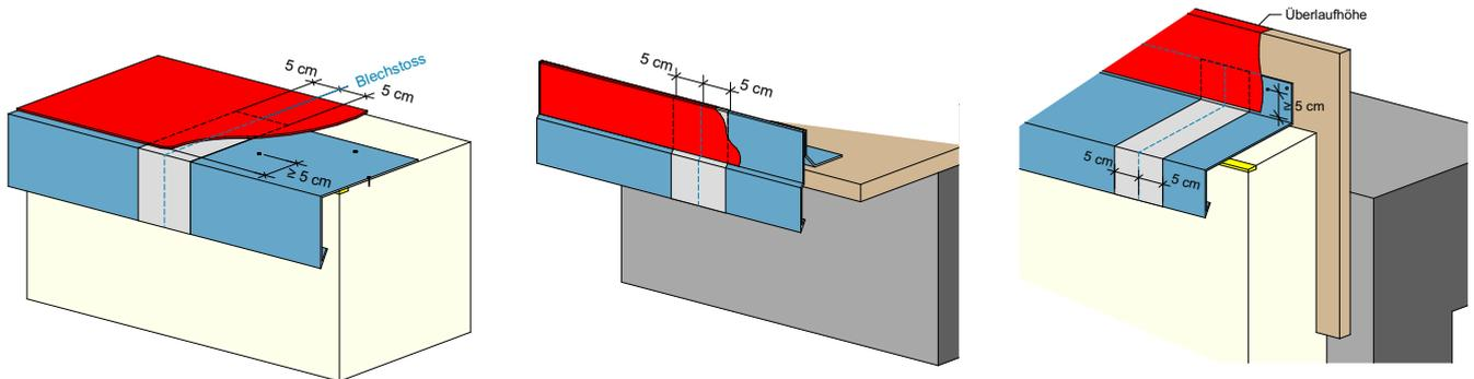
Abb. 10: Ausbildung der Blechstösse bei überlaufsicheren Dachrandkonstruktionen
