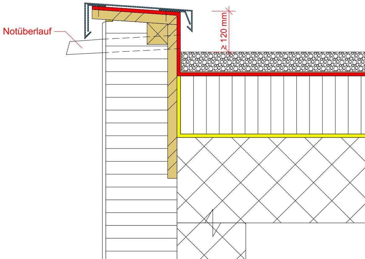
Abb. 29: Nicht überlaufsichere Dachrandkonstruktionen
