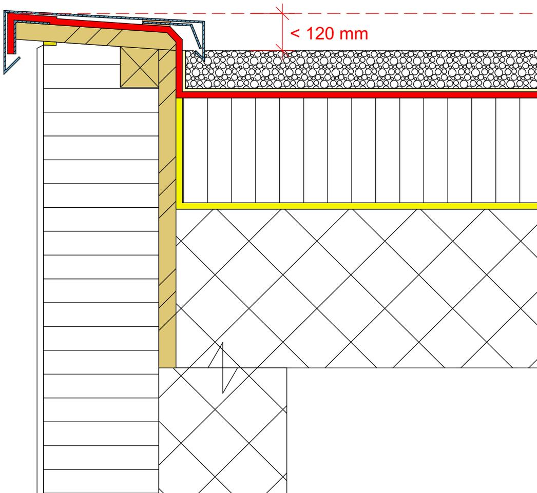
Abb. 30: Überlaufsichere Dachrandkonstruktionen
