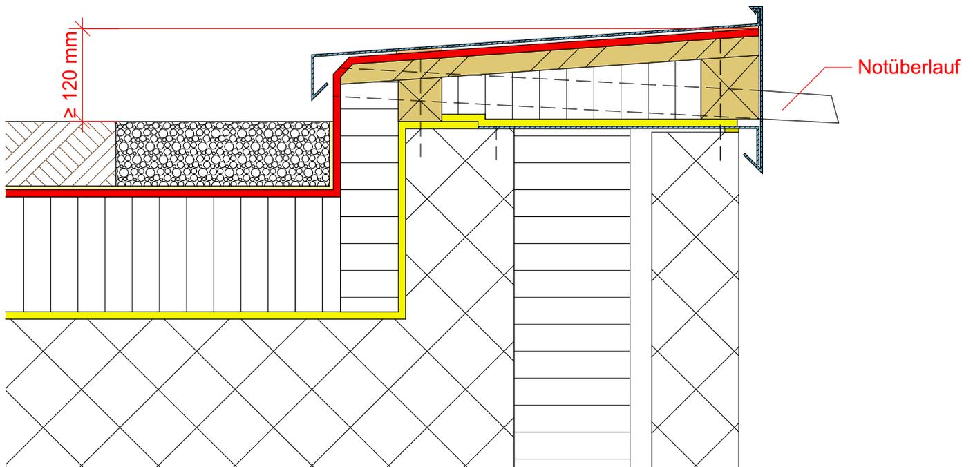
Abb. 31: Nicht überlaufsichere Dachrandkonstruktionen
