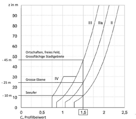
Abb. 3: Profilbeiwert  $c_p$  in Abhängigkeit von der Höhe  $z$
