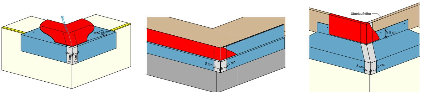
Abb. 11: Ausbildung der Gehrungen bei überlaufsicheren Dachrandkonstruktionen
