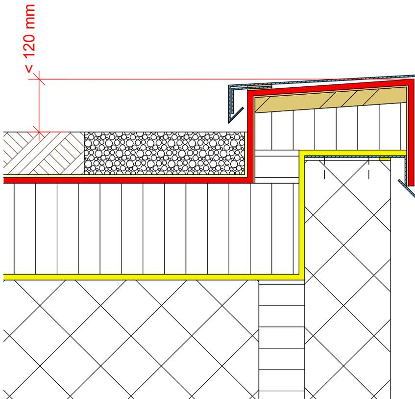
Abb. 32: Überlaufsichere Dachrandkonstruktionen
