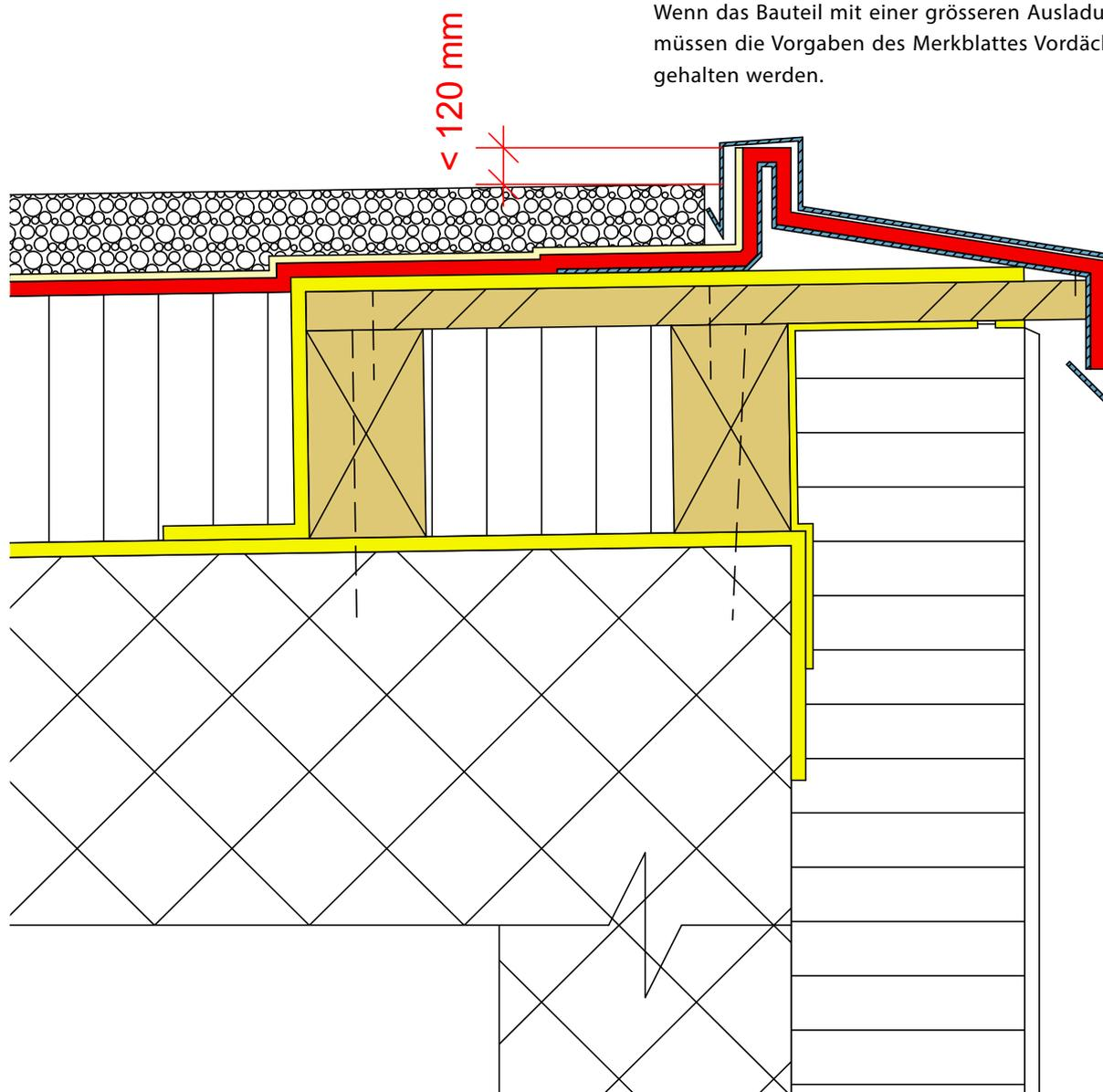
Abb. 36: Überlaufsichere Dachrandkonstruktionen
