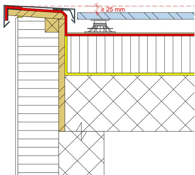
Abb. 28: Überlaufsicherer Dachrand muss mindestens 25 mm über der Schutz- und Nutzschrift geführt werden. Norm SIA 271:2021 Art. 2.8.1.6 Figur 8
