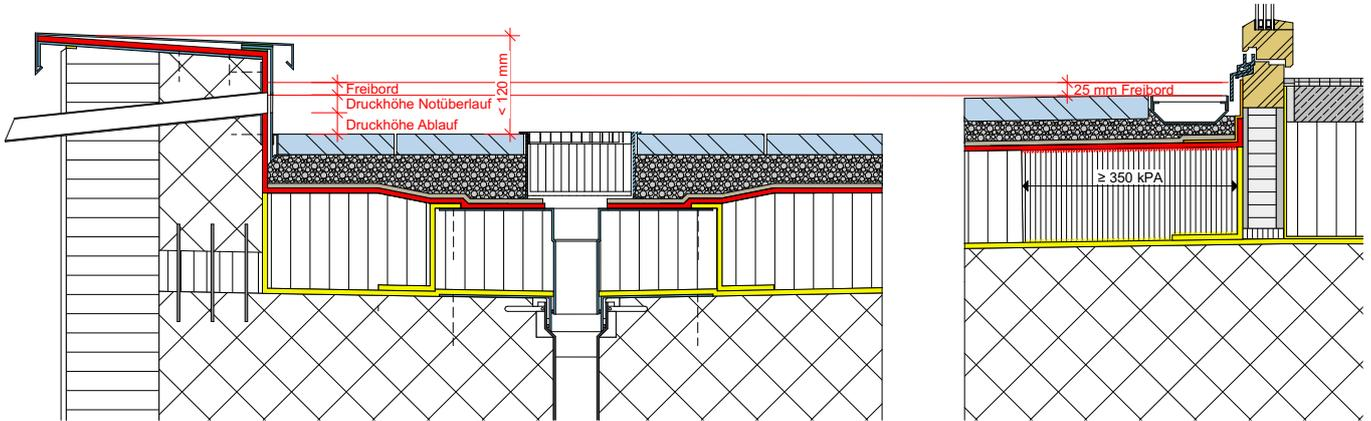
Abb. 8: Überlaufsichere Ausführung mit Notüberlauf
