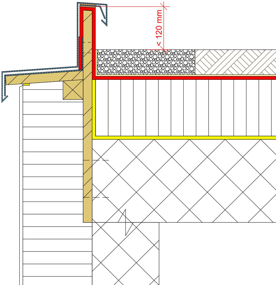
Abb. 34: Überlaufsichere Dachrandkonstruktionen
