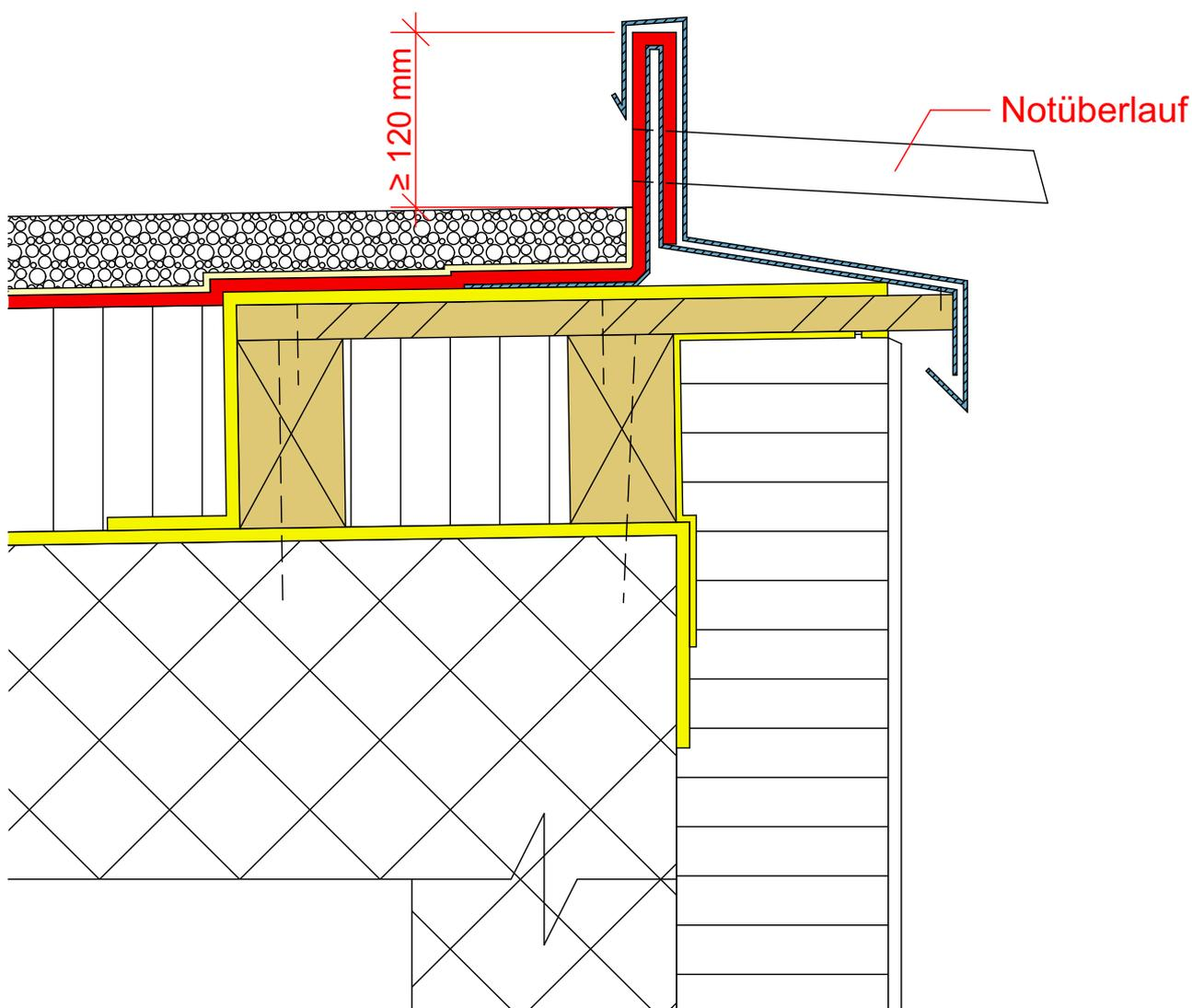
Abb. 35: Nicht überlaufsichere Dachrandkonstruktionen
